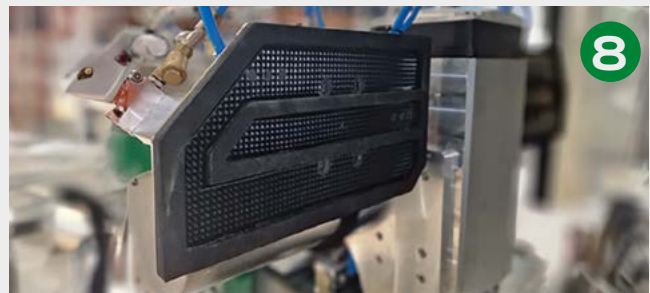
Manipulator with suction cups BI-ZONA for moving of work-pieces Manipolatore a ventose Bi-ZONA per lo spostamento dei pezzi.
