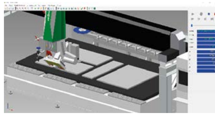
3D simulation of the programming performed / Simulazione 3D della programmazione effettuata
