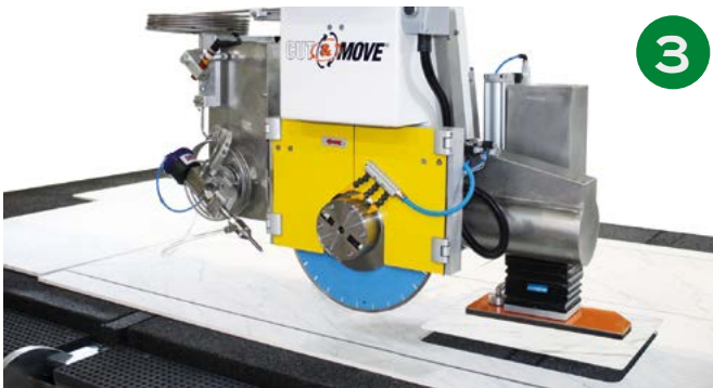
Removal of waste material / Rimozione del materiale di scarto
